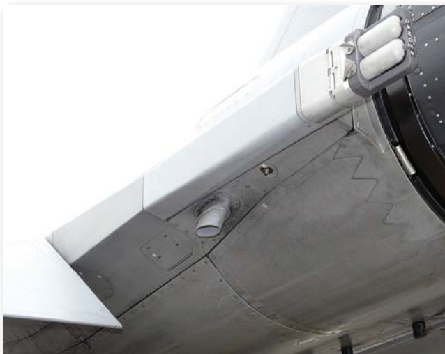
Цик-цак ивице, прекознајљива мера усмеравања радарских зрака, карактеристика су свих авиона са смањеним радарским одразом. На „рафалу“ је ова конструкција обилази коришћена око радума, излазних ивица канарда и крила, на убодницима и око издувника, на врашанцима сјајног шрапа ...
